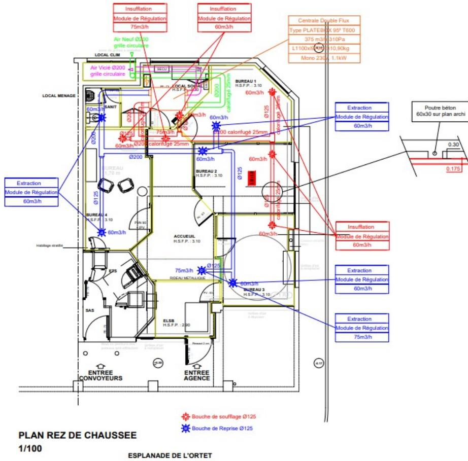
Et ici le plan VMC avec les emplacements des différentes bouches de soufflage et de reprise. L'emplacement de la C.T.A qui sera dans le local technique ainsi que des grilles de rejets et d'aspiration d'air neuf.
