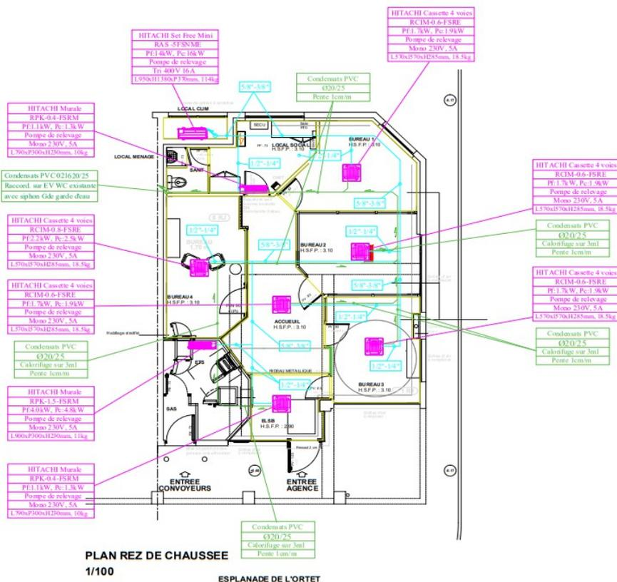
Nous avons ci dessus le plan avec le détails des emplacements des différentes unités, des liaisons frigorifiques à utiliser, mais aussi des évacuations des condensats
